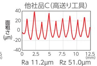
使用設備：立形M/C BT50 被削材：S50C インサート：WNMU 0807ZNER-G (ACU2500)
