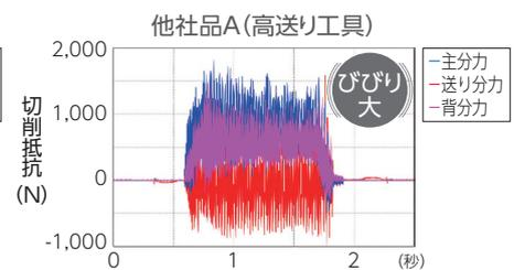
使用設備：立形M/C BT50 被削材：S50C 使用工具：DMSL 06020E03 ( $\phi 20$  3枚刃)
